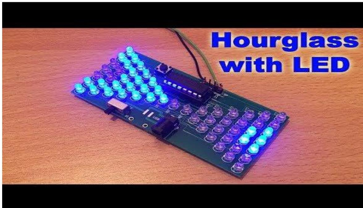
Attention! Aussi !!! Les Leds ont deux pattes, l'une est plus grande que l'autre. La patte la plus courte est à raccorder au - et la plus longue patte est à raccorder à la borne + . Regarder avec attention la vidéo!
